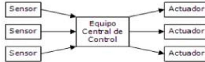
ESTRUCTURA REDES DE AUTOMATIZACIÓN Y CONTROL
